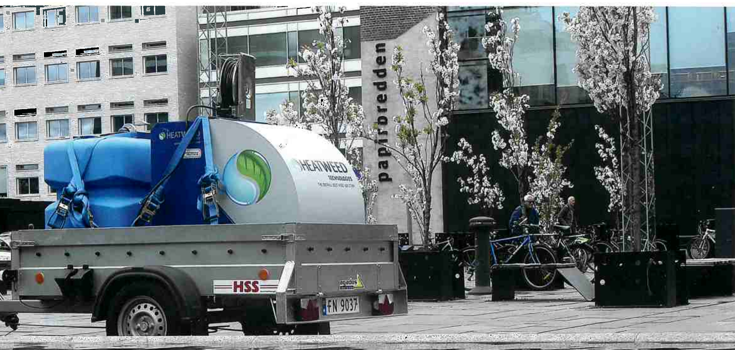
Svensk Markservice, Sveriges största markskötsel företag, har beslutat att intensifiera sina miljöinsatser. Ett led i den satsningen är ogräsbekämpning med hetvatten. Företaget har redan 13 sådana här maskiner av märket Heatweed ute på fältet, och fler kommer inom kort.
